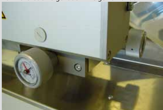
Abb. 6: Mikrometer Spindeln zur Siebfeineinstellung
