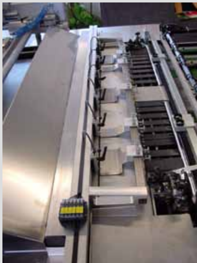
Abb. 3: Anlegebereich der THIEME 5000
