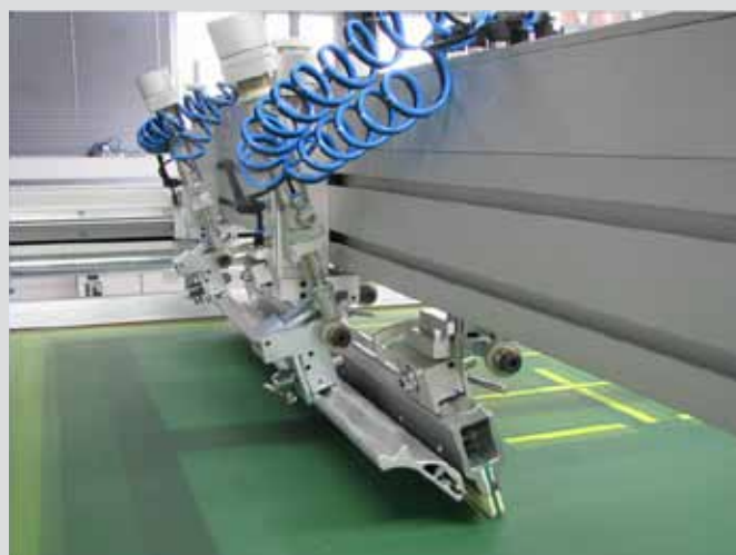
Abb. 11: Antitropfeinrichtung beim Drucken Pic.11:
