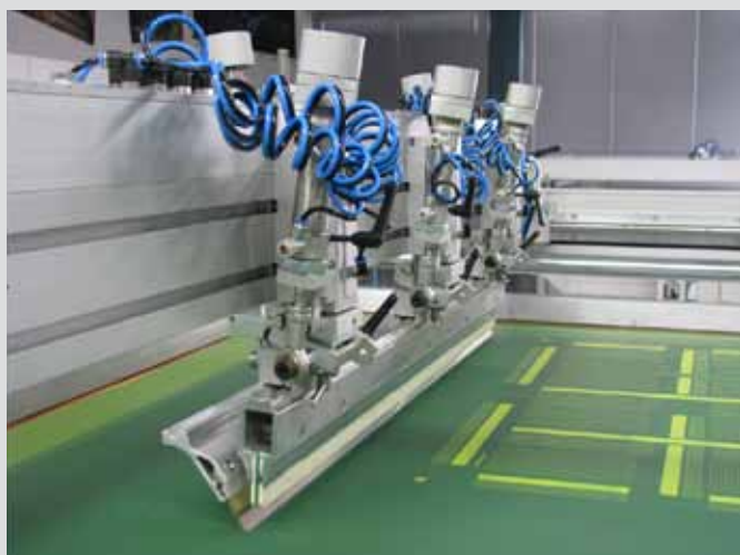
Abb. 10: Antitropfeinrichtung beim Fluten Pic.10:
