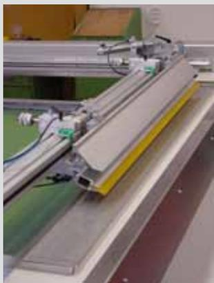
Abb. 4: Optionale 90° Rakelschwenk-Vorrichtung
